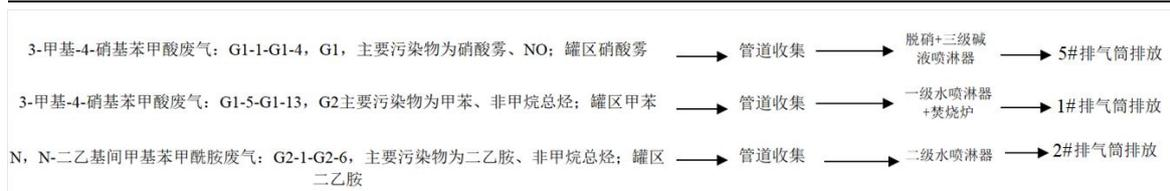
图 4.1-2 废气处理工艺流程图
